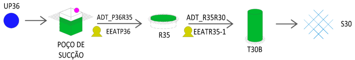
Figura 3.72 – Fluxograma do abastecimento do setor com indicação das adutoras, VRP e estações elevatórias
