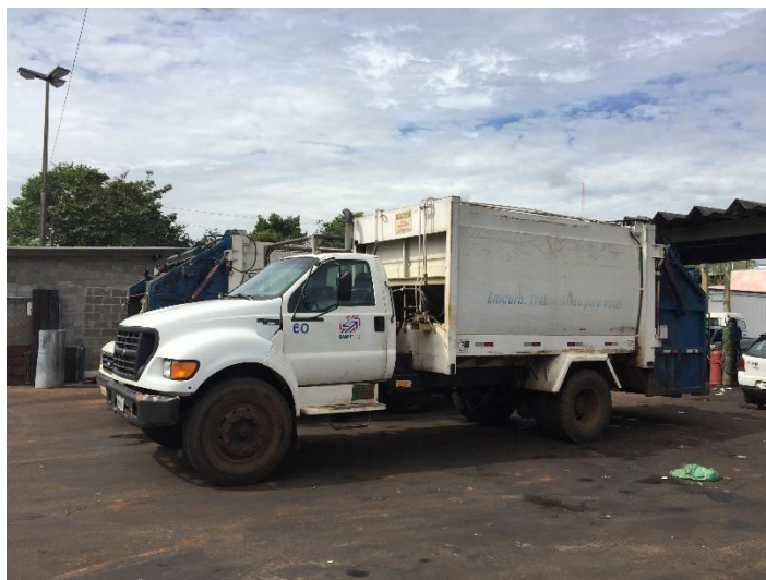
Figura 33: Caminhão Coletor - Coleta Convencional
