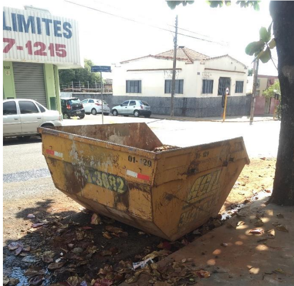
Figura 13: Caçambas para o Transporte de RCC
